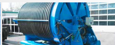
BACKHUS HD S Радиоуправление – Барабан для шланга с 3- и 4-дюймовым патрубком
