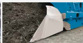
Гидравлические Расчиститель колес с автоматическая адаптация с поверхностью площадки
