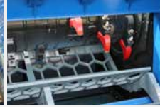
Hohe Produktqualität durch zusätzlichen, optionalen Siebkorb
