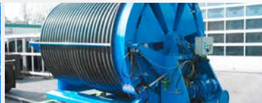
BACKHUS HD S, Funkgesteuert – die Schlauchtrommel mit 3- und 4-Zoll-Anschluss
